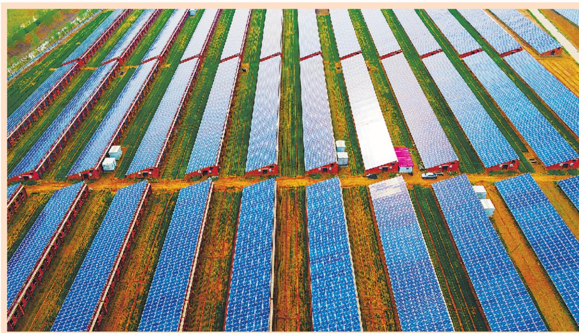
南乐县元村镇农光互补产业园建设项目由生态农业项目和太阳能发电站项目组成。其中:生态农业项目规划建设144座生态农业大棚;太阳能发电站项目利用生态农业大棚棚顶13万平方米,安装78624块多晶硅太阳能电池组件,并入国家电网同步运行。项目建成投入运营后,将实现年销售收入4600万元,提供就业岗位800余个,提高农民收入,助力脱贫攻坚。图为项目现场。
