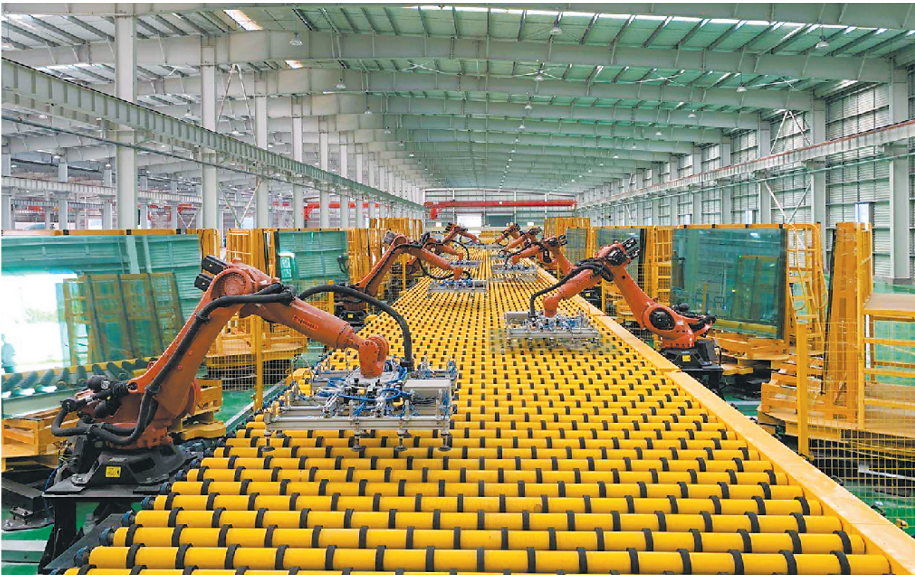
位于濮阳县产业集聚区的中建材(濮阳)光电材料有限公司，拥有国内首条拥有自主知识产权的超白光热玻璃生产线，填补了国内市场空白，打破了国外技术垄断，在发挥科技引领、支撑县域经济发展等方面，具有极强的带动作用。该生产线现在每天生产玻璃360吨，主要销往河北、山东等地。图为7月21日，生产线上的机械手正在整理成品玻璃。
