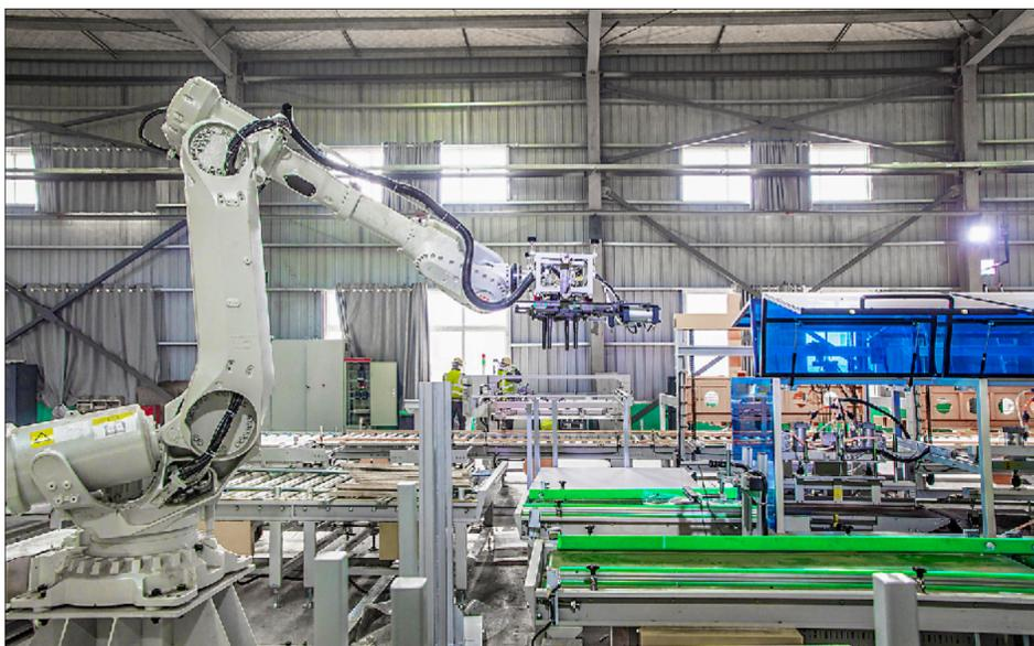
位于工业园区的濮耐新材料科技有限公司数字化转型项目由全自动配料系统、液压成型系统、机器人智能码垛系统、3D视觉智能检测系统等组成,生产时通过各系统间的协作互联完成整线的稳定运行,实现物料配制、混练、成型、烘干、烧制、后道自动加工及转运、成品包装等整个工艺流程的自动化、智能化。今年5月正式投产后,可减少人员60%,提升效率60%,实现年营业收入3亿元。
