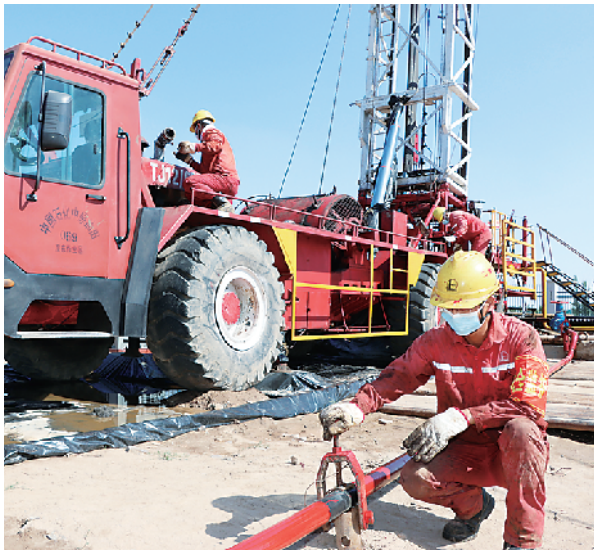
6月27日,中原油田采油工程服务中心濮南作业区作业 604 队在储气库白 36 侧井进行施工前的井控安全检查。该中心抓实井控安全管理,严格执行特殊井、重点井井控措施,做到“一井一案”,确保管控措施有效执行。 本报记者 王庆红 通讯员 孙博 摄
