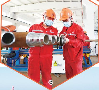
图②:中原石油工程公司管具公司钻具检修中心质检员对每根待出厂钻具的紧密距、螺距等参数进行测量,确保出厂合格率100%。
