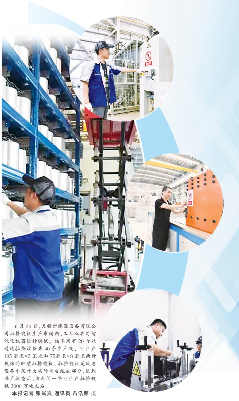
6月20日,天顺新能源设备有限公司拉挤玻板生产车间内,工人正在对智能化机器进行调试。该车间有20台双通道拉挤设备共40条生产线,可生产105毫米×5毫米和75毫米×8毫米两种规格的轻质拉挤玻板。拉挤玻板是风电设备中风机大梁的重要组成部分,达到满产状态后,该车间一年可生产拉挤玻板3000万吨左右。
