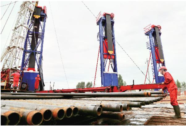
近日,中原油田最新引进的新式抽油机——塔式抽油机投入使用。该型抽油机相较老式“磕头机”具有占地少、维护方便、自动化程度高、故障率低等优点,是中原油田推进“源网荷储”一体化智慧油田建设的重要举措。图为6月20日,在中原油田文卫采油厂卫10-62井塔式抽油机井场,工人正在进行下管套作业。⑮
